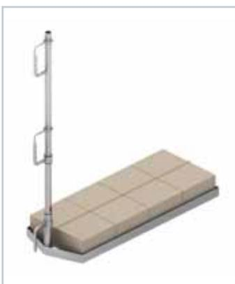
Die Struktur des Gegengewichthalters ermöglicht seine Benutzung praktisch an allen Tragkonstruktionselementen eines Gebäudes. Zur Stabilisierung des Gegengewichthalters sollte man 4 Betonblöcke mit den Abmessungen 380 x 230 x 120 mm, 380 x 240 x 120 mm oder 380 x 250 x 120 mm nach PN-EN 771-3 und einem Eigengewicht von mind. 23 kg benutzen. Der Halter entspricht den Anforderungen der Norm PN-EN 13374 der Klasse A.
