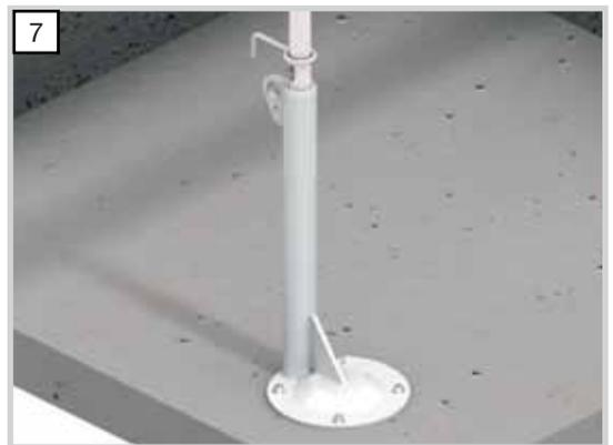
Der Eindrehalter 500 mit eingebautem Geländerpfosten
