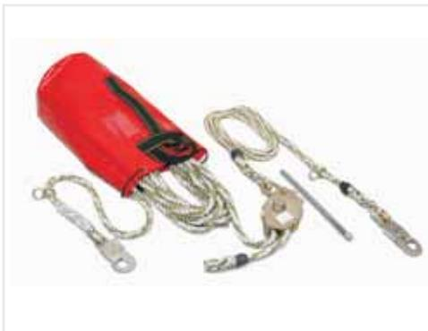
Die Polyamideleine Durchmesser 16 mm besitzt einen Spannungsmechanismus und Kupplungselemente aus Stahl. Die Leine ist für einen Arbeiter vorgesehen. Dieses Element entspricht den Anforderungen der Norm PN-EN 795 und besitzt ein Sicherheitszertifikat CE. Leinenlängen: 10, 20 und 30 m.
