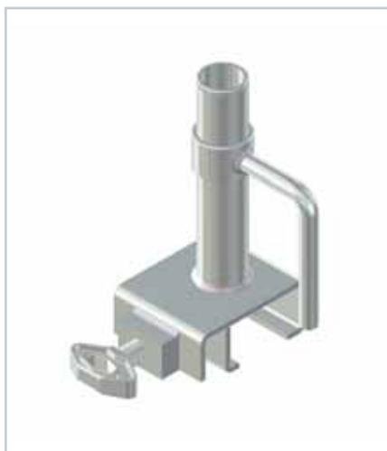
Der Schraubenträgerhalter ermöglicht Montage von Systempfosten auf Holzträgern mit Höhen 160, 200 und 240 [mm]. Der Halter wird an dem oberen Trägerflansch mit h=40 [mm] und Breite 60 [mm] befestigt.
