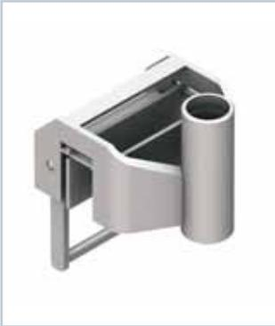
Der Halter für Autobord dient zur Montage auf dem Autobord mit Stärken bis 25 mm. Die Befestigung erfolgt durch Einlegen des Halters auf dem Bord und Sicherung durch Exenterklemme. Der Halter wird aus attestiertem Konstruktionsstahl mit galvanischer Verzinkung hergestellt, was seine langzeitige Nutzung unter normalen Bedingungen garantiert.
