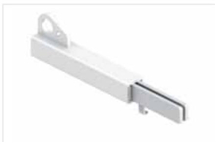
Das Verlängerungsstück des Seitenhalters 290 dient zur Montage des Seitenhalters. Es ermöglicht seine Anwendung im Abstand von 290 mm von der äußeren Wandfläche, in der die Hülse des Seitenhalters befestigt wurde. Die dauerhafte galvanische Verzinkung (Tauchmethode) ermöglicht eine jahrelange Nutzung des Elementes.
