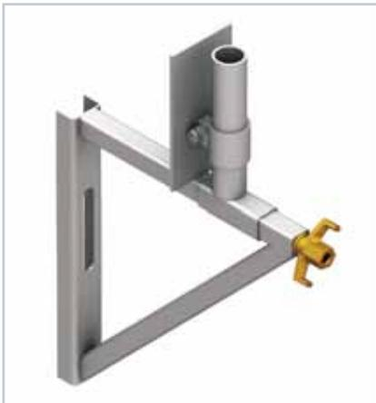
Der einstellbare Schalungshalter dient zur Befestigung des Geländerpfostens mit gleichzeitiger Möglichkeit der Seitenschalung der Deckenplatte oder der Schalung eines über die Gebäudeflucht hinausragenden Gebäudeelements. Die in diesem Halter befestigten Geländerpfosten erschweren die Bewehrungsarbeiten und die Deckenbetonierung nicht, da der Geländerpfosten außerhalb der Seitendeckenschalung unter Beachtung der Vorschriften des Arbeitsschutzes befestigt wird.
