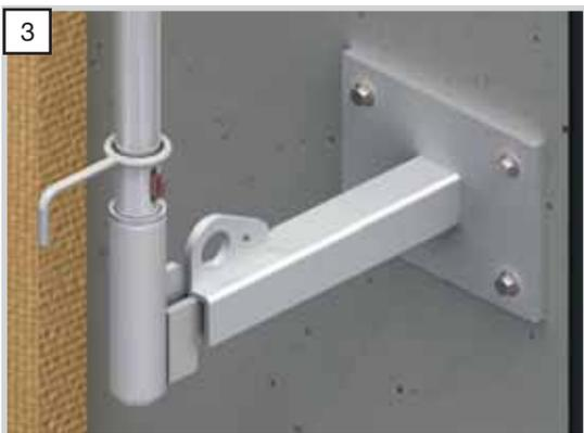
Montage des Geländerpfostens mit dem Seitenhalter an der universalen Stahlhülse 260
