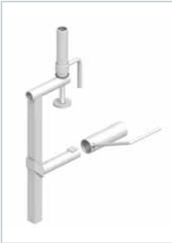
Der Treppenhaken mit dem Universalhalter ermöglicht die Montage der Schutzgeländer auf Treppen, in denen es vorher keine Seitenschutzhalter gab oder aus verschiedenen Gründen die Montage von Eindrehaltern unmöglich ist, z.B. wenn man keine Bohrungen für Anker durchführen kann.
