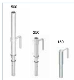
Das Verlängerungsstück dient zur Verlängerung der Geländerpfostenhöhe. Das obere Geländer (gem. Vorschriften) soll sich auf einer Höhe von 1,1 m über dem Arbeitsniveau befinden. Die Anwendung des Verlängerungsstückes ist erforderlich, wenn der Pfosten im Seitenhalter (zum Beispiel auf Treppenläufen), im verlorenen Halter, Schalungshalter und einstellbaren Schalungshalter eingebaut wird.
