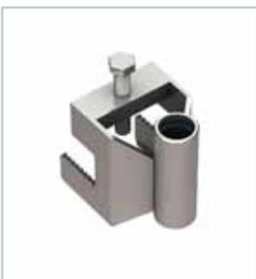
Halter für Stahlkonstruktionen dienen zur Montage auf Stahlprofilen mit Elementstärken von 40 [mm]. Die Befestigung erfolgt durch Auflegen des Halters auf das Stahlelement und die Sicherung durch Einschrauben der Halterschraube.
